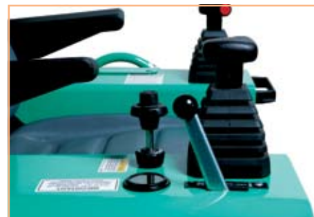
Control de velocidad de rotores, este dispositivo le permite al operador fijar la velocidad de los rotores a una velocidad constante sin tener que presionar el control de pedestal constantemente, reduciendo la fatiga que representa operar a bajas revoluciones
